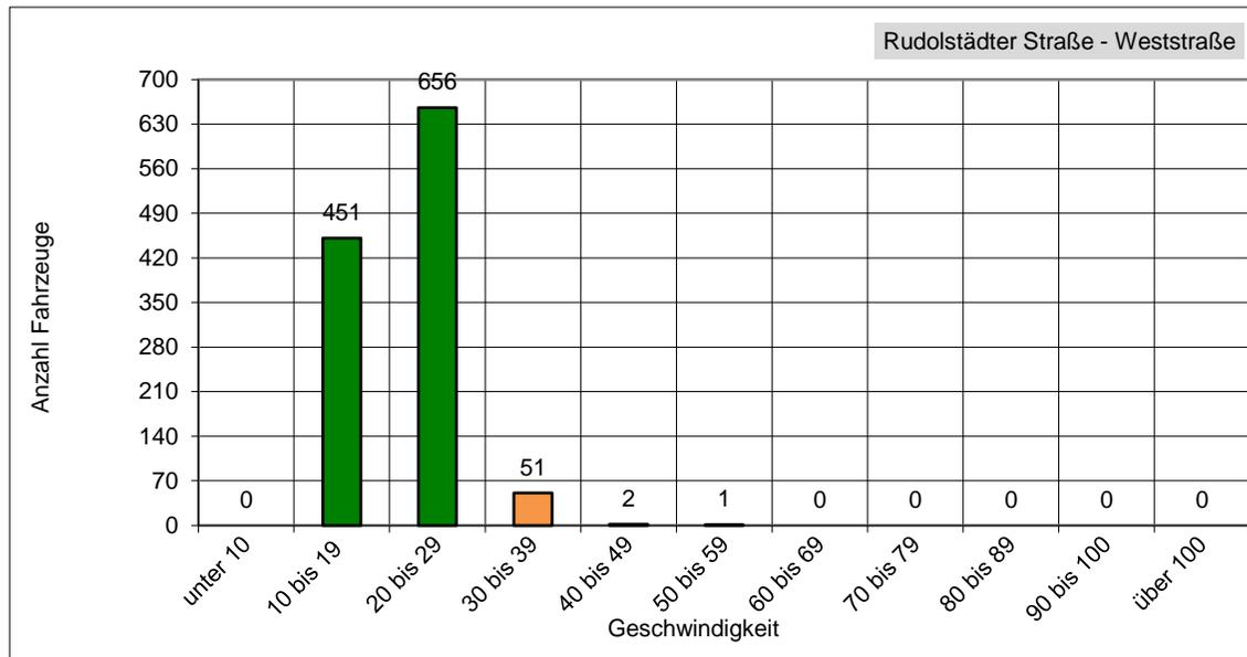
**v85:** Dieser Wert wird in km/h ausgegeben und bedeutet, dass 85% der gemessenen Fahrzeuge diese Geschwindigkeit nicht überschritten haben. Dieser Wert ist maßgeblich für ggf. weitere verkehrsrechtliche Maßnahmen. Je näher der Wert der v85 an der zulässigen Höchst- geschwindigkeit am Messort liegt, desto besser.
