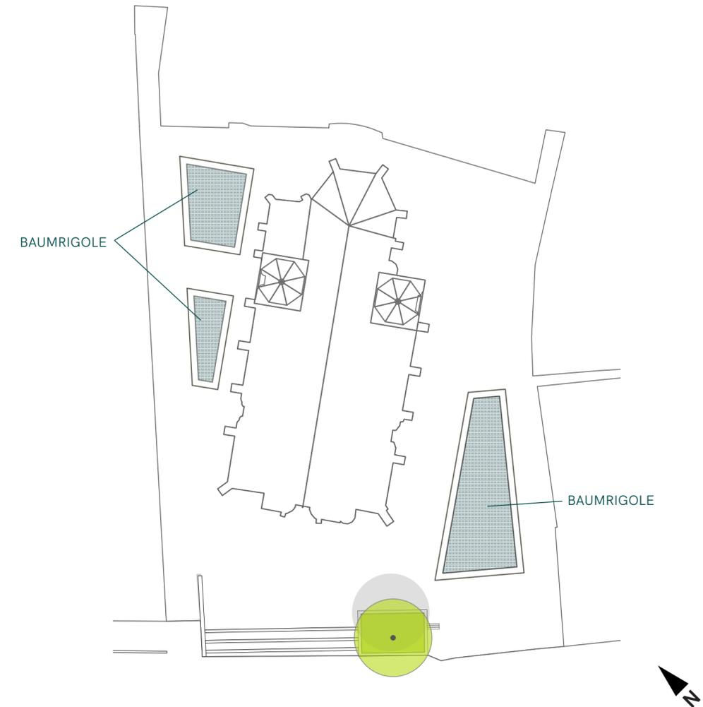
**BAUMRIGOLE - UNTERIRDISCHER WASSERSPEICHER**
