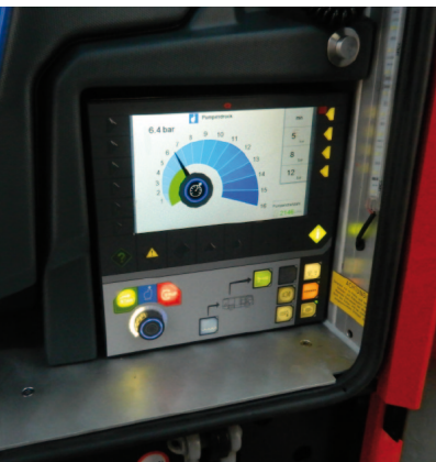
Bedienungsteil des HLF 10. (Quelle: Freiwillige Feuerwehr Saalfeld)
